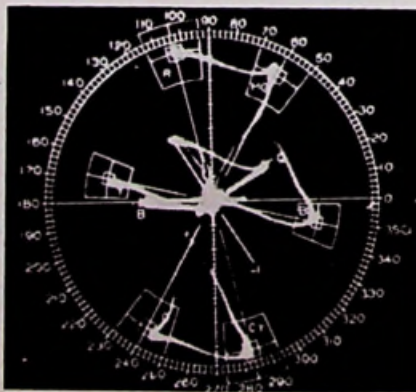
Afb. 20. Spanningsoscillogram (boven) en vectordiagram (onder) van het Amerikaanse NTSC-toets signaal.
